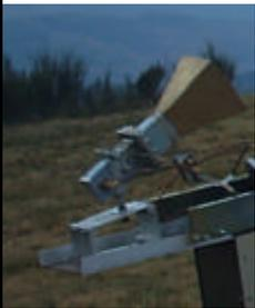
**La transition et le cornet d'illumination** de la parabole:
